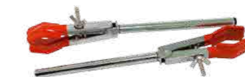
Лапка двупалая (для колб), максимальный захват – до 60 мм.
